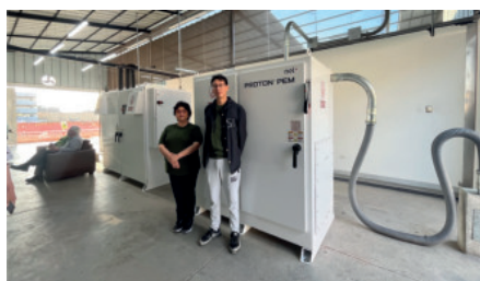
F1 Electrolizador PEM - Serie C producción de Hidrógeno 30 Nm 3 /h | 65 kg/día
