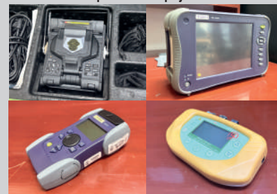
fusionadora de fibra óptica INNO View IFS-10, Reflectómetro de Dominio de Tiempo Óptico (OTDR), atenuador de nivel óptico portátil JDSU OLA-55 y medidor selectivo de potencia óptica PROMAX PROLITE-67.
