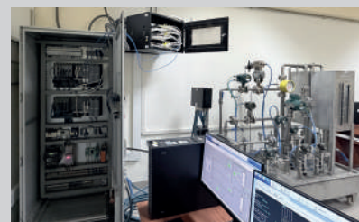
Unidad de entrenamiento de procesos instrumentada, tablero de control industrial gestiona automatización y procesos complejos.
